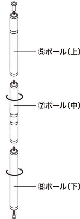
**3** ②底板に各ポールを差し込み、底板固定用ビスでしっかりと固定します。同じく、①天板に、各ポールを差し込み天板固定用ビスでしっかりと固定してください。その際、図のように商品を寝かせた状態で組み立ててください。
